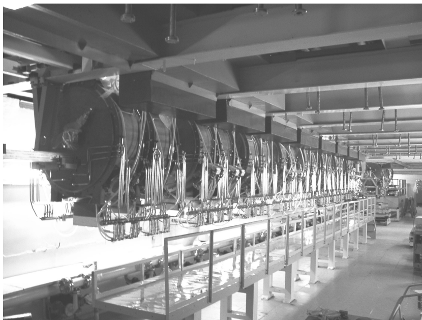
Рис. 13. Ускоряющая система ускорителя-рекуператора, состоящая из 16-ти 180 МГц резонаторов. Полностью запущена в августе 2001 г.
