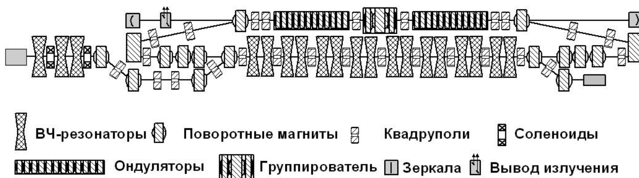
Рис. 12. Схема однопорожечного ускорителя-рекуператора и субмиллиметрового ЛСЭ.
